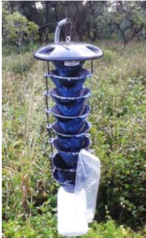
Figura 13. Trampa multiembudo de 8 unidades “Lindgren”. Fuente: CNRF
